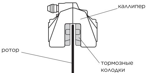
Роторы всегда должны располагаться по центру между тормозными колодками с зазором около 1 мм между колодкой и ротором.
