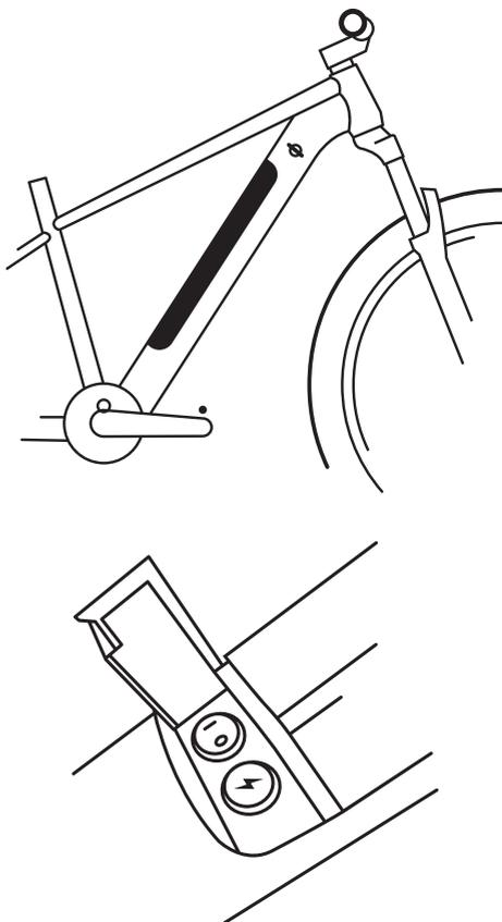
Перед поездкой откройте крышку на нижней трубе рамы, расположенную под аккумуляторной батареей. Нажмите переключатель, чтобы включить/выключить аккумулятор. Разъем с защитной пластиковой крышкой предназначен для зарядки.
