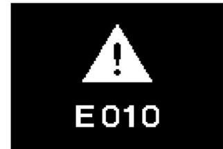
В случае возникновения сообщения об ошибке, Вам следует в первую очередь, перезагрузить систему. Для этого выключите электропривод клавишей на батарее, снимите батарею, установите её заново и включите электропривод. В случае, если перезагрузка системы не помогла или сообщение об ошибке появляется повторно, пожалуйста, обратитесь к дилеру или дистрибьютору TITAN RACING.
