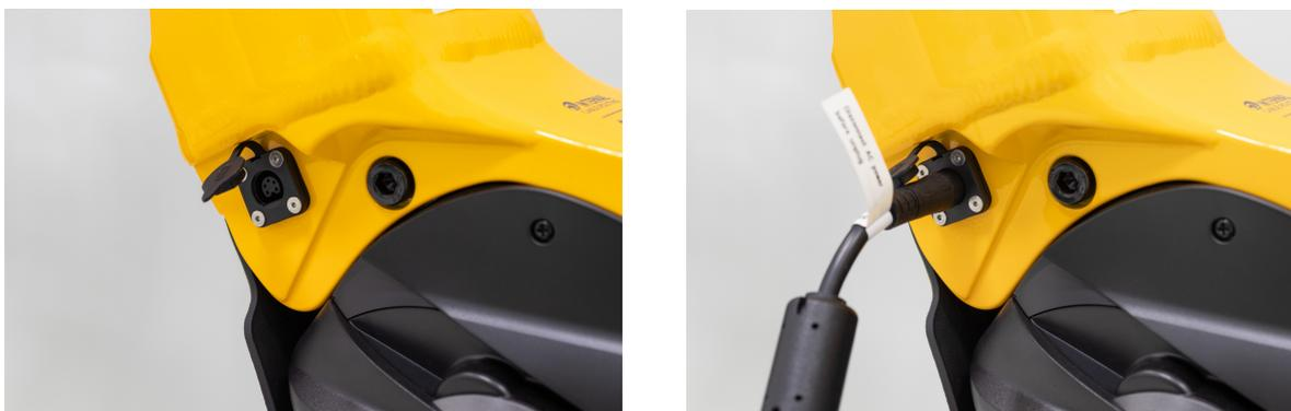
Подключите зарядное устройство к электровелосипеду и вставьте вилку зарядного устройства в розетку. Начнётся зарядка батареи, текущий уровень заряда батареи отображается с помощью индикатора на зарядном устройстве:
