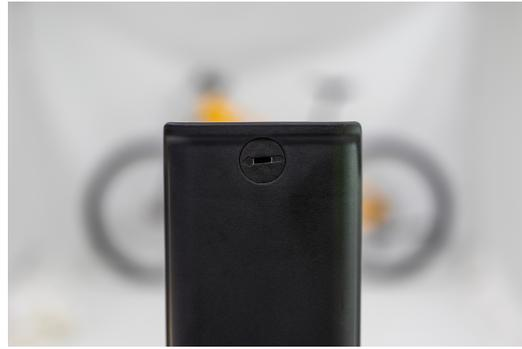
Снимите защитную заглушку замка батареи и вставьте ключ в замок. Поверните ключ и откройте замок батареи. Батарея переместится в положение, удерживаемое предохранительной защёлкой. Нажмите на предохранительную защёлку и извлеките батарею из рамы велосипеда.
