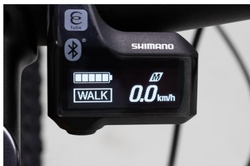
Ваш электровелосипед оснащён режимом WALK. Этот режим позволяет активировать электропривод без вращения педалей, например, при ходьбе с велосипедом в гору. Для включения режима WALK, необходимо нажать нижнюю клавишу выбора режимов на две секунды и дождаться отображения режима WALK на дисплее. Включения режима WALK возможно только в случае, если Ваша скорость равна нулю (Вы стоите на месте). Для активации электропривода в режиме WALK нажмите нижнюю клавишу ещё раз и удерживайте её.
