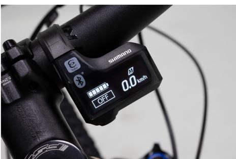
Дисплей Вашего электровелосипеда оснащён функциями велокомпьютера. На дисплее, помимо информации о выбранном режиме поддержки при педалировании, может отображаться текущая скорость, заряд батареи, дневной и общий пробег и множество другой полезной информации.
